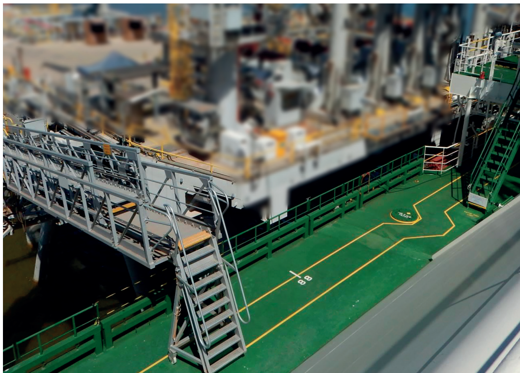
Рисунок 10: Лестница установлена перпендикулярно борту и обеспечивает безопасный выход на палубу
