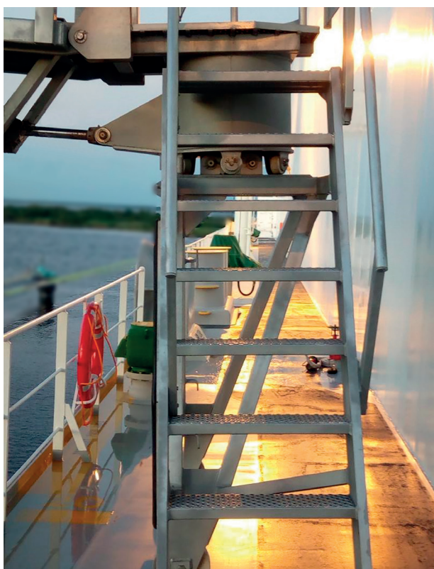
Рисунок 11: Постановка лестницы в районе надстройки с обеспечением свободного прохода в кормовую и носовую части палубы судна
